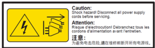
图 8-2 多电源安全防护
